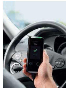
4. Geaccepteerde ademtest: vrijgave van het startcircuit.
